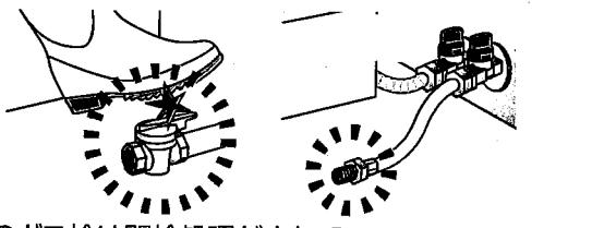
未使用のガス栓は閉栓処理がされていないと、接触等による誤解放によってガス漏れ事故につながります。未使用のガス栓はガス販売店へ連絡し、正しく処理してください。
