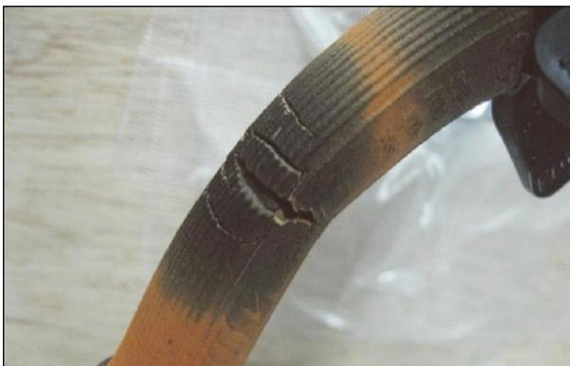
また、金属フレキシブルホースの接続された燃焼器を頻繁に移動させると、金属疲労により損傷します。
