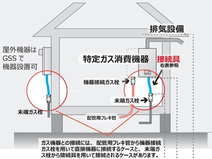
LPガス機器におけるガス接続工事（取り付け・取り外し）には、液化石油ガス設備士の国家資格が必要です。
