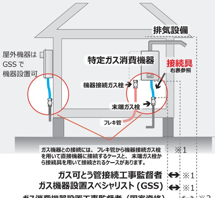
都市ガス機器におけるガス接続工事（取り付け・取り外し）には、以下の民間資格が推奨されています。
